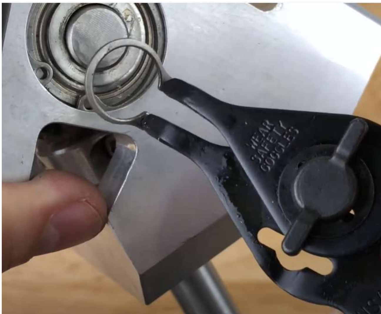
Attrezzo per l'estrazione dell'anello di sicurezza.
